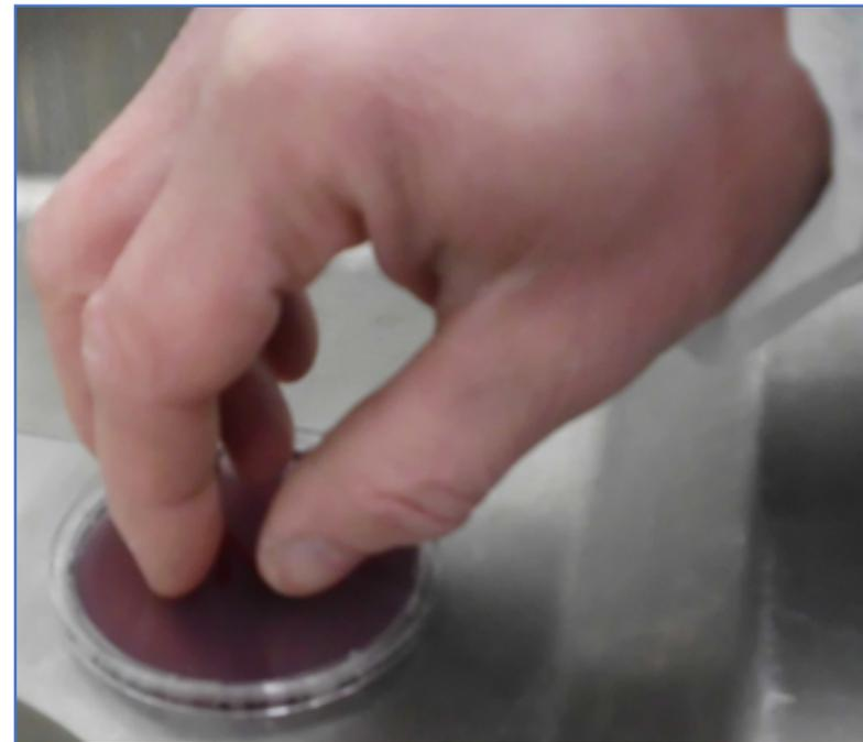
**Mit möglichst gleichem Druck die überstehende Agaroberfläche ca. 10 Sekunden auf die Testoberfläche drücken.**
